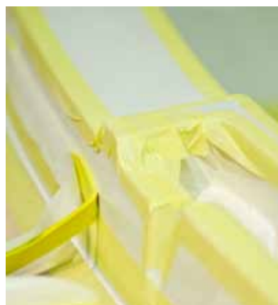
De tacky tape moet een kleine overlap hebben met het schilderstape, ongeveer 3 mm.
