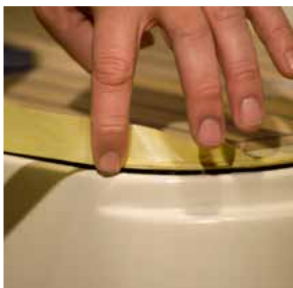
Plak met schilderstape de schip-delen rondom de af te kitten naden af.
