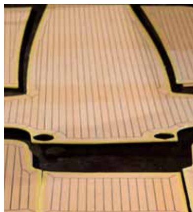
Plak schilderstape langs de randen aan de bovenzijde van de Esthec® panelen.
