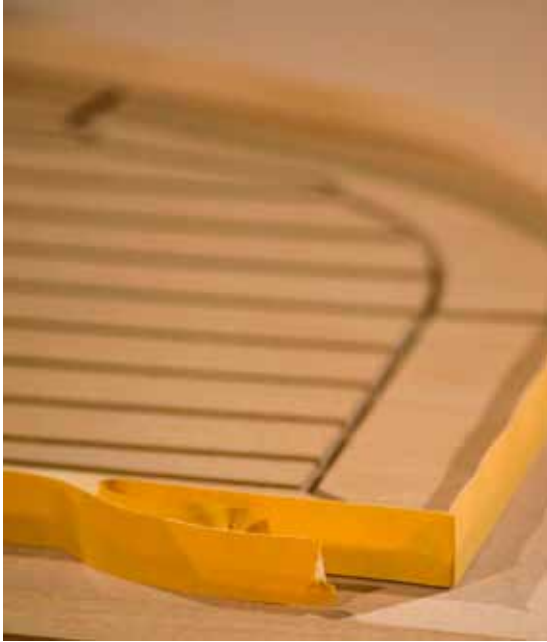
Gebruik tochtband of tacky tape om de Esthec® panelen af te plakken.
