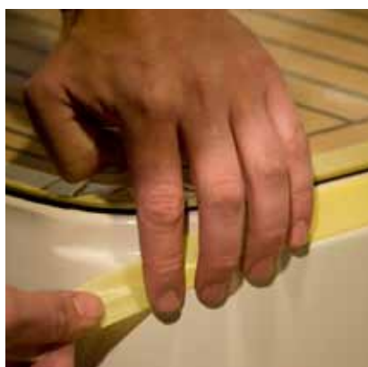
Plak met schilderstape de schip-delen rondom de af te kitten naden af.
