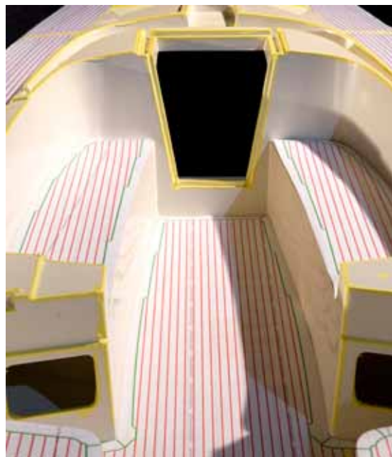
Til de folieprint op en leg deze over de juiste delen van het scheepsdek totdat al het folieprint op de juiste plaats ligt en controleer de maatvoering.
